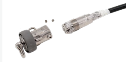
Schieben Sie die Hülse über die Leine und legen die Seele über die Konen. Führen Sie die Konen in die Hülse.
